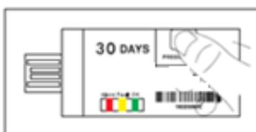
4 – Corte o invólucro plástico e conecte o Termógrafo Wise-USB na porta USB de seu PC. Aguarde por aprox. 30 segundos, até que o relatório gráfico em PDF seja gerado automaticamente.
