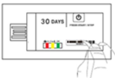
3 – **DESEMBARQUE:** Aperte o botão "START / STOP" e segure por 5 segundos, até que o Led vermelho pisque por 3 vezes. Isso significa que o Termógrafo Wise -USB encerrou o ciclo de gravação de Temperatura.
