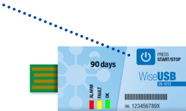
03 - Comprovação de ativação: O Led Amarelo (Delay) piscará nos 30 minutos iniciais em período de 'Start Delay'. Após esse período, o Termógrafo passará a gravar normalmente os dados de Temperatura.
