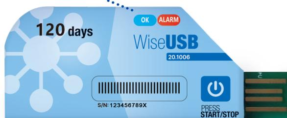
03 - Prueba de activación: El LED azul parpadeará cada 10 segundos en los 30 minutos iniciales, durante el período de 'Inicio retrasado'. Después de este período, el termógrafo comenzará a registrar los datos de temperatura normalmente.
