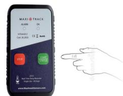
2 - Através do Portal Galileo Sensors, finalize as gravações. Depois de clicar no botão END e depois de cumprido o intervalo de sincronização, o Data Logger será parado.
